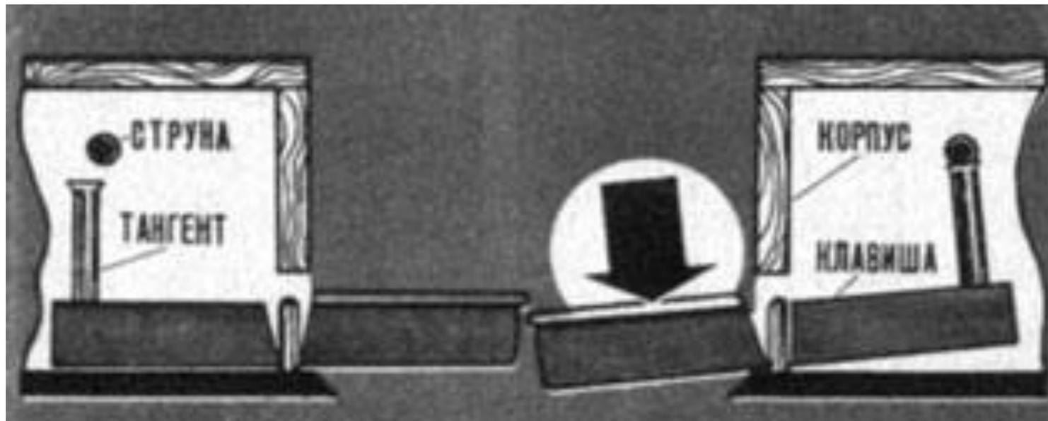
Тангент клавикорда вделан в задний конец клавиши. Струна располагается над тангентом. Если нажать клавишу, тангент поднимется и ударит струну.
