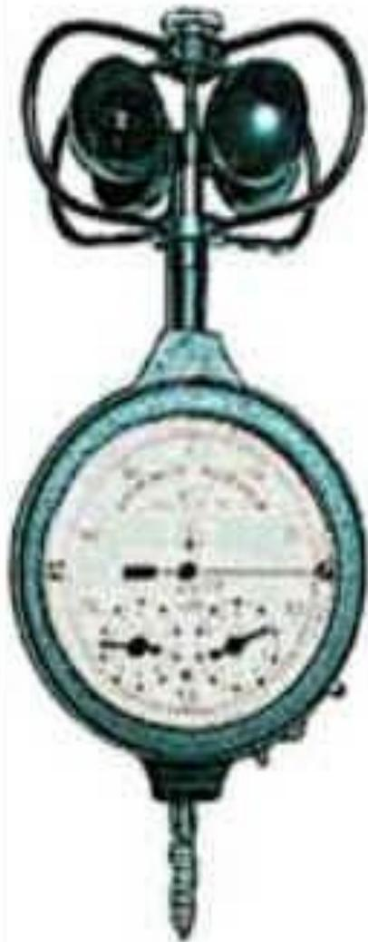
предназначен для измерения средней скорости направленного воздушного потока в промышленных условиях и средней скорости ветра на метеорологических станциях.
