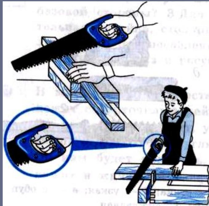
Стусло – приспособление для распиливания заготовок под углом в  $90^\circ$  или  $45^\circ$ . Применение стусла повышает производительность и увеличивает точность обработки.
