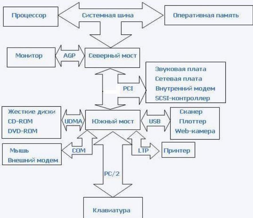
**Электронная вычислительная машина (ЭВМ)** — комплекс технических средств, предназначенных для автоматической обработки информации в процессе решения вычислительных и информационных задач.
