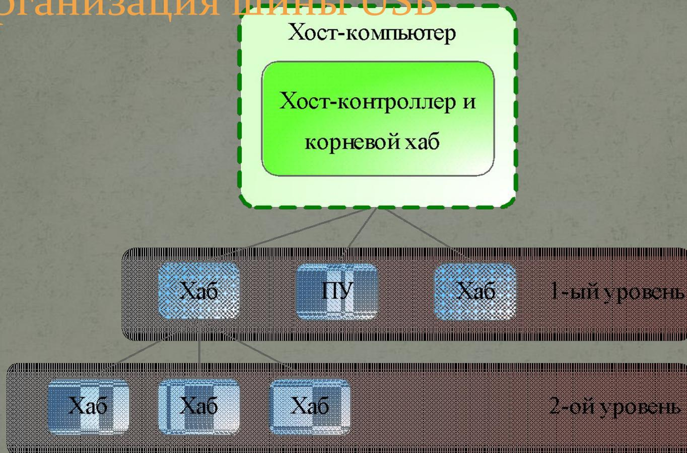
Физическая топология шины USB – **многоярусная звезда**.
