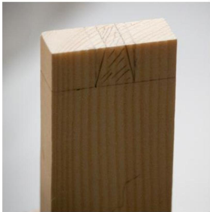
После разметки производят продольное запиливание и долбление проушины. При необходимости зачищают напильником.
