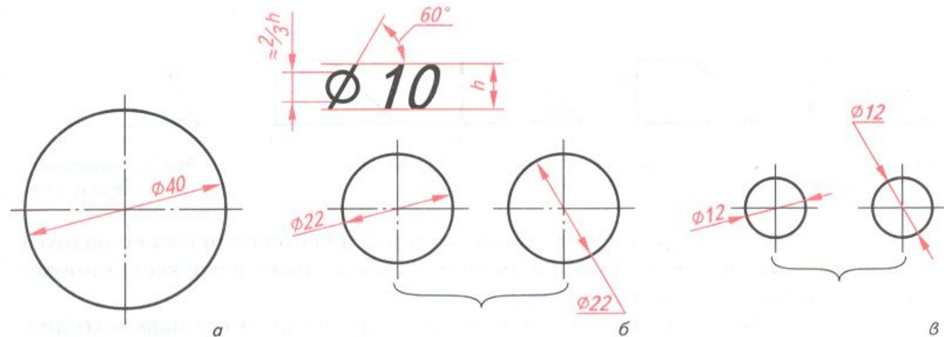
Рис. 68. Нанесение размеров окружности
