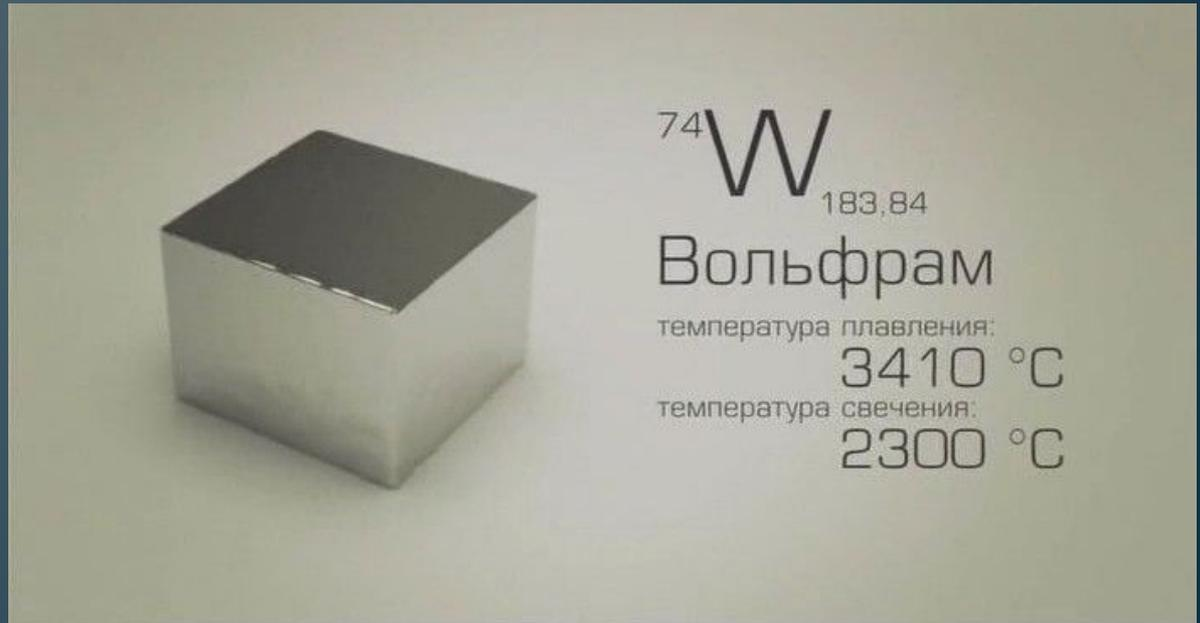
Вольфрам является одним из наиболее тяжелых, твердых и самых тугоплавких металлов. хорошо поддается ковке и может быть вытянут в тонкую нить.
