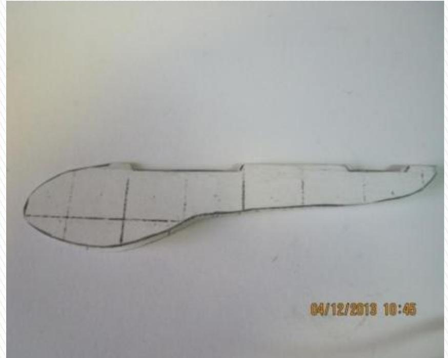
Вырезаем фюзеляж по контуру.
