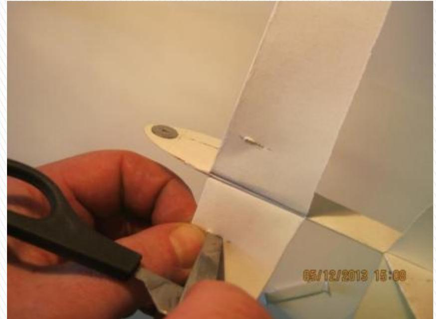
С помощью ножниц сделаем прорези в крыльях и установим лонжерон на клей .
