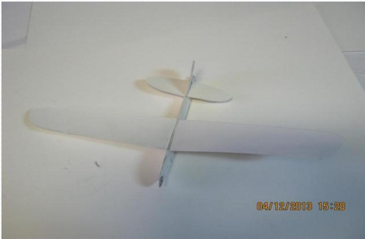
Устанавливаем киль “верхом” на лонжерон, места соединения стабилизатора, киля и лонжерона промазываем клеем. Также устанавливаем груз.
