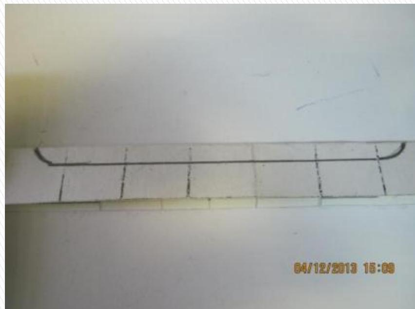
Вырисовываем лонжерон фюзеляжа по 6 – ти клеткам и вырезаем его.
