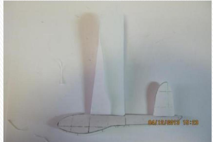
Крыло и стабилизатор в месте с лонжероном проденем снизу в прорези фюзеляжа. Следить за тем, чтобы крыло и стабилизатор были установлены прямо по отношению к фюзеляжу.
