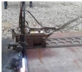
3. Услуги резки секатором листового проката от 4мм до 300 мм
