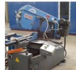
5. Услуги резки лентопильным станком сортового проката до 320мм
