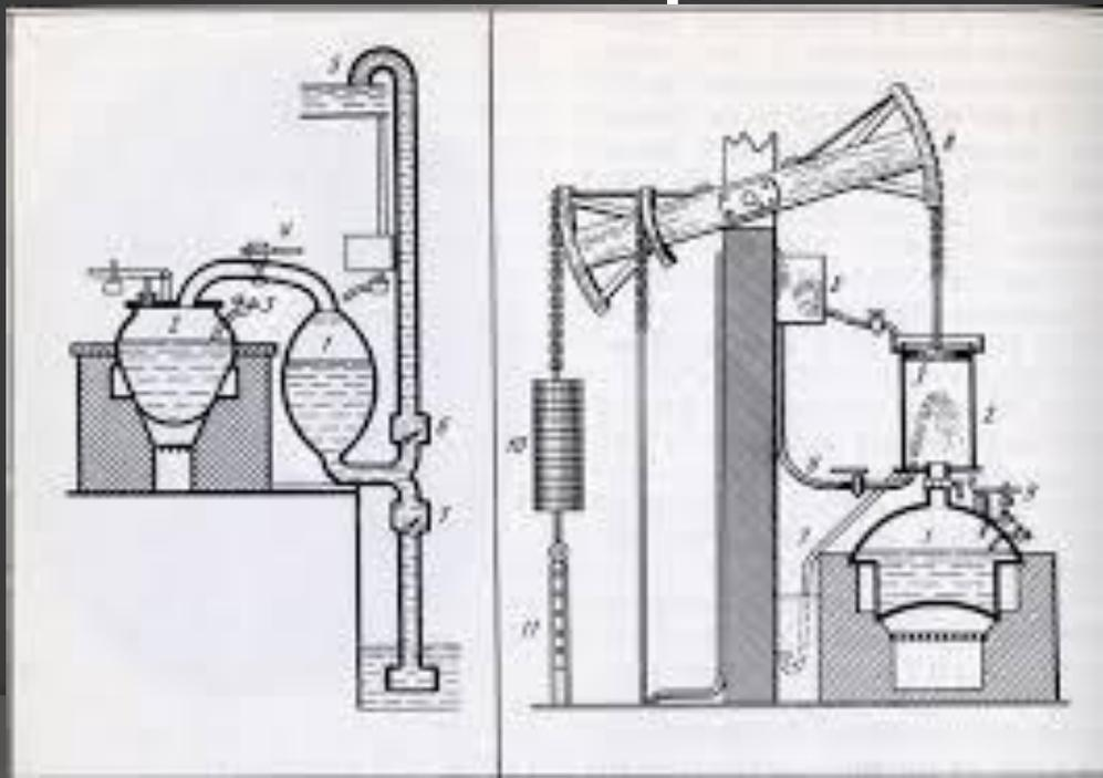
Работа, производимая атмосферным давлением, тем больше, чем больше ход поршня и сила давления на него. Перепад давлений при этом зависит только от температуры, при которой пар конденсируется, и сила, равная произведению перепада давлений на площадь поршня, увеличивается при увеличении площади поршня, то есть, диаметра цилиндра и, следовательно, объема цилиндра. Совокупно получается, что мощность машины растёт с ростом объёма цилиндра.
