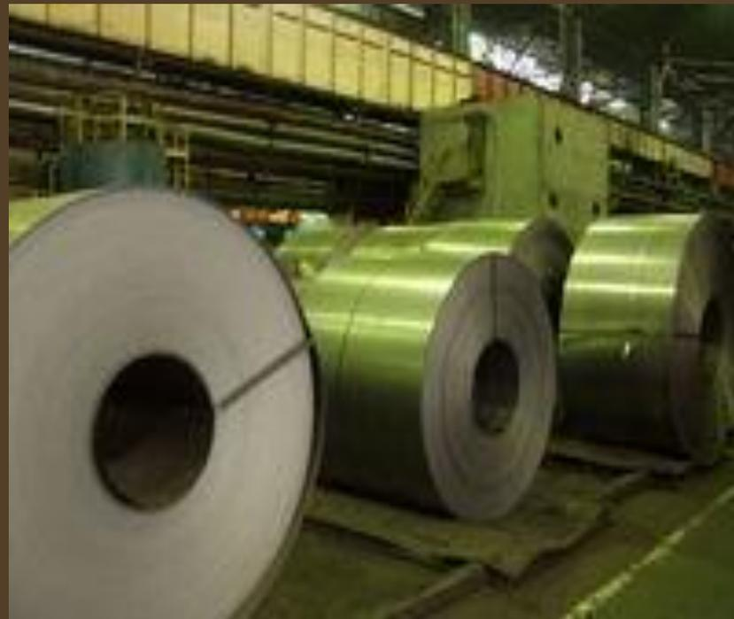
На адьюстаже производится складирование прокатанных на стане рулонов металла, отгрузка их потребителю, дальнейшая обработка рулонов на агрегатах поперечной резки № 1 и № 2 для разделки их на лист. С агрегатов поперечной резки пачки листов поступают на склад готовой продукции для упаковки обручкой, а также на агрегат нормализации для термообработки ЛИСТОВ.
