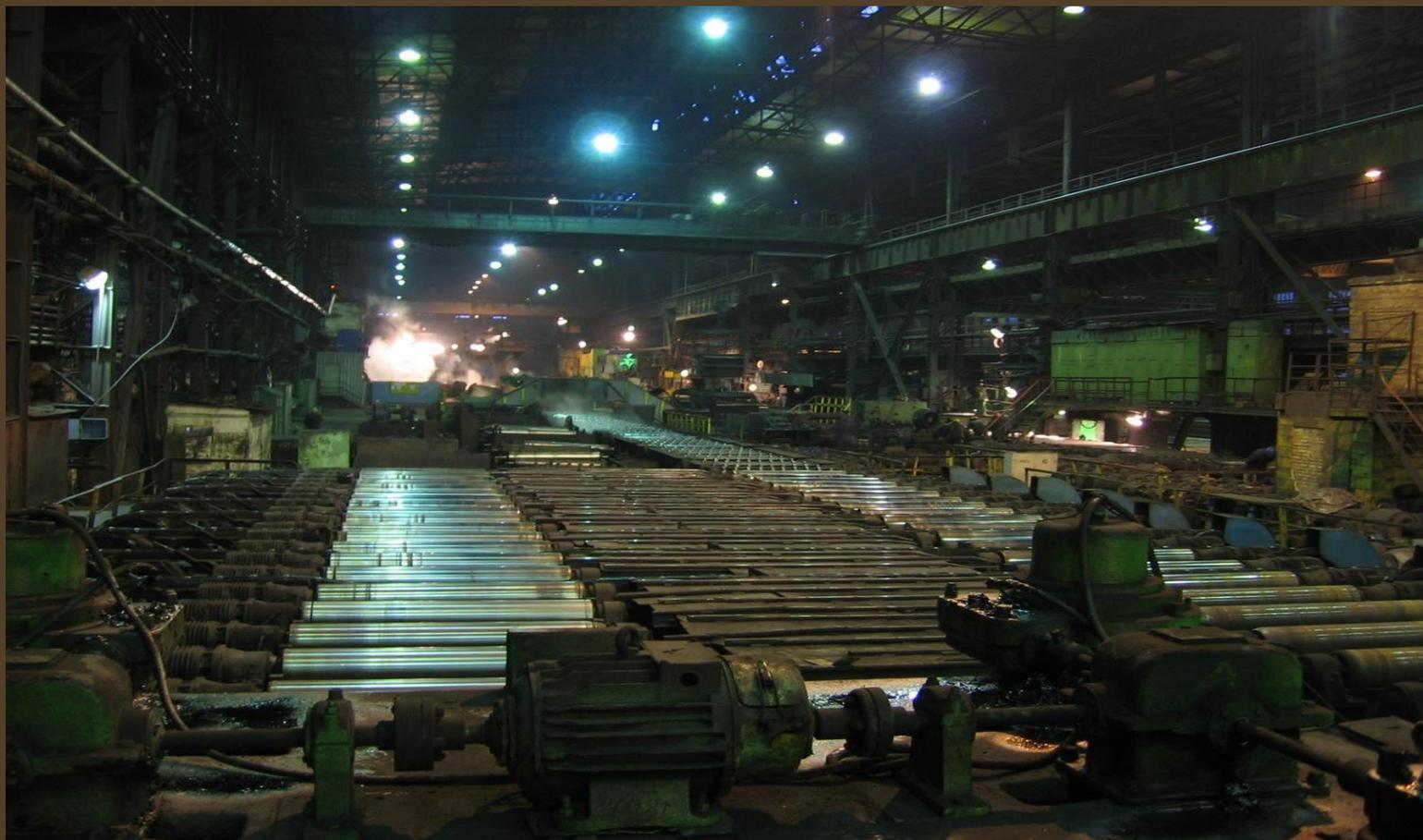
Линия отделки толстого листа: правильные машины, обрезка переднего и заднего концов, обрезка по ширине, УЗД
