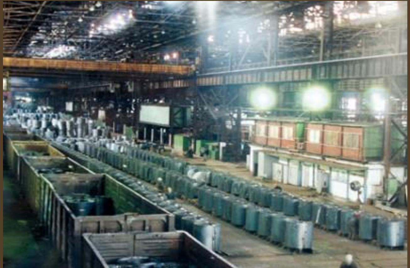
ЛПЦ № 1 производит горячекатаную рулонную и листовую сталь, подкат для цеха холодной прокатки толщиной 2,0-12 мм, шириной 900-1500 мм.
