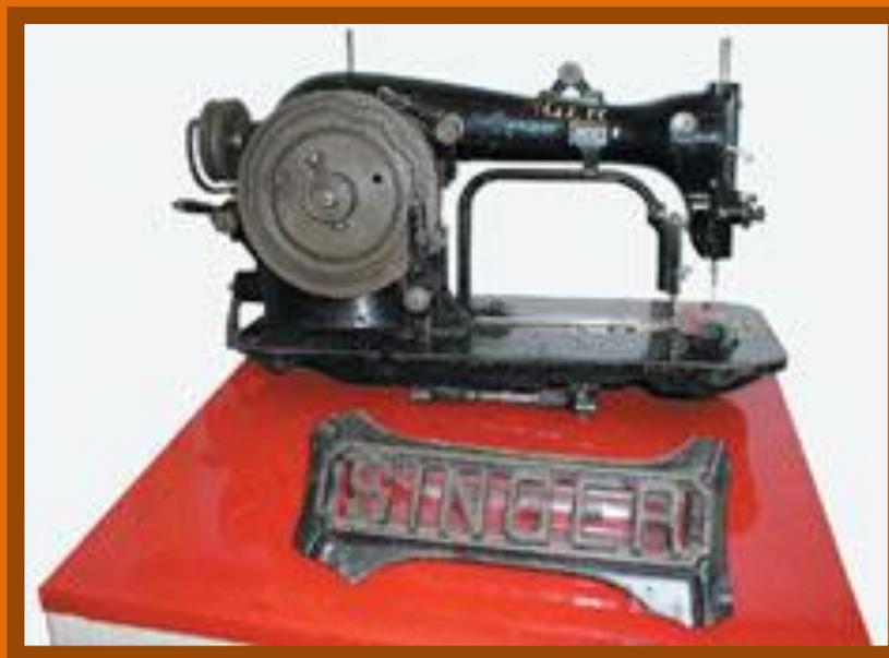
*Фабрично-ремесленная сапожная швейная машина челночного стежка для пришивания подошвы к голенищу подольского завода компании "Зингер». На этой машине мастер-ремесленник тачал и ремонтировал обувь.*
