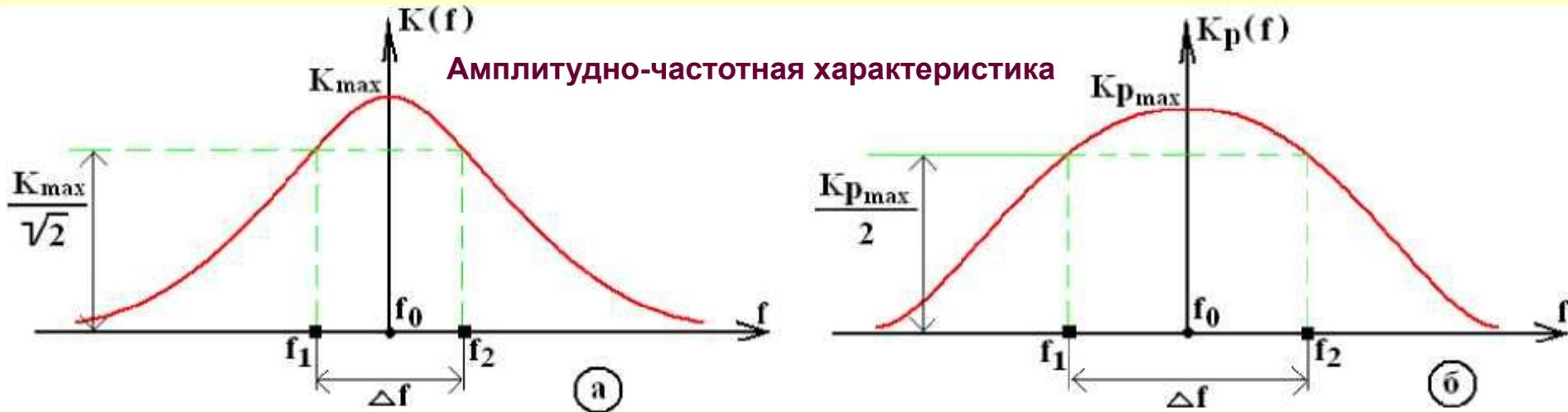
Количественно частотная избирательность приемника характеризуется его полосой пропускания  $\Delta f$ . **Полоса пропускания** определяется как разность частот  $f_2$  и  $f_1$ , для которых  $K$  уменьшается в  $\sqrt{2}$ , а  $K_p$  - в два раза от своего максимального значения. Избирательность приемника тем выше, чем ближе форма его амплитудно-частотной характеристики к П-образной.
