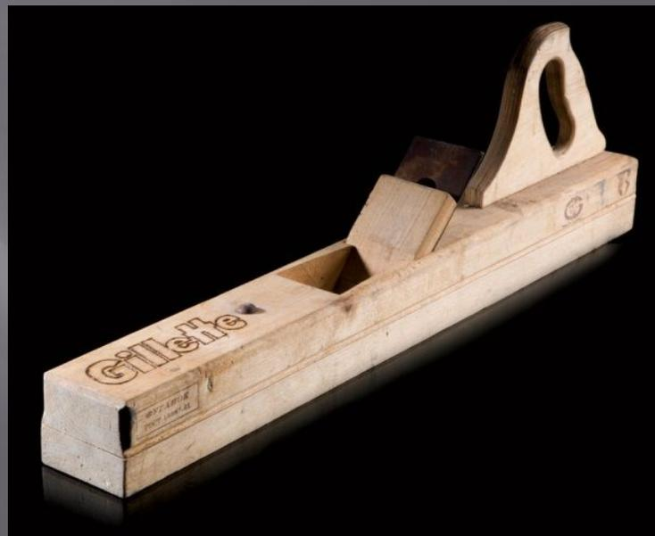
**Рубанки и фуганки состоят из ножа, корпуса и клина для закрепления ножа в корпусе. Для удобства пользования рубанки могут иметь рог и упор**
