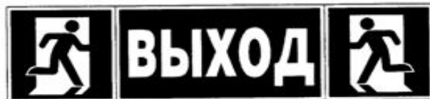
Конечный эвакуационный выход (при наличии двух направляющих линий в коридорах шириной более 2 м и помещениях большой площади) 2)
