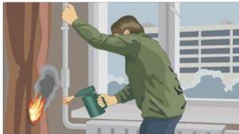
Отогревание замёрзших труб газовыми лампами и факелами
