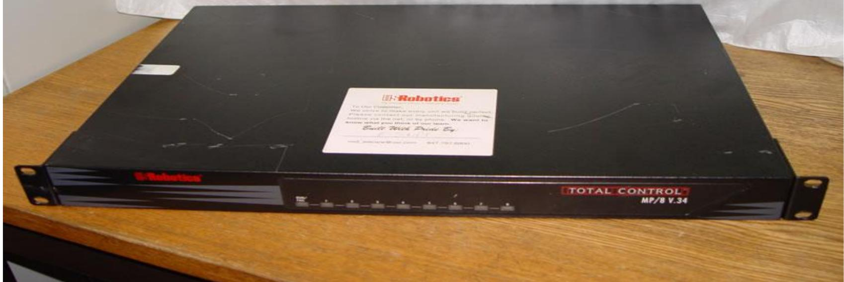
**LAN-модем** — комбинация модема и маршрутизатора, имеющая в качестве интерфейса, обращенного к оконечному оборудованию, сетевой порт (обычно Ethernet). Позволяет одновременно пользоваться одним выходом во внешний мир группе абонентов локальной сети.
