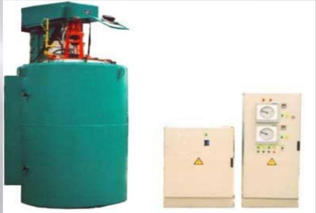
Цементируют детали, работающие в условиях трения, при больших давлениях и циклических нагрузках, например шестерни, поршневые пальцы, распределительные валы и др.
