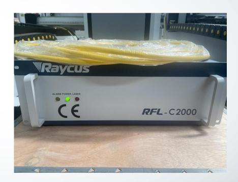
( 9 ) Не включайте кнопку START на лазере . Примечание. Нажмите на эту кнопку лазер не будет излучать, он находится в состоянии тревоги , и лазер красный загорится будет включено.
