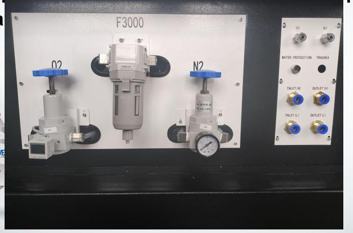
кислород давление на выходе контролируется в пределах 1m
