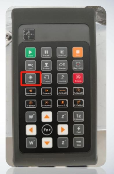
Raycus лазер должен открыть затвор , когда готовится разрезать. После того, как красный свет на лазерной головке погаснет, вы можете начать резку
