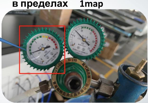
Азот на выходе давление контролируется в пределах 2Мар
