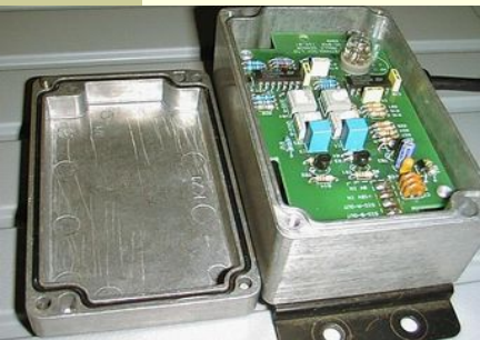
Датчик нахилу для коригування даних урожайності
