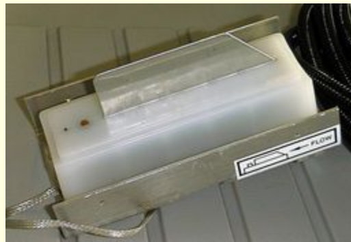
Датчик вологості: частота вимірювань - від 1 разу за 20 сек., до 1 разу в 2 хвилини
