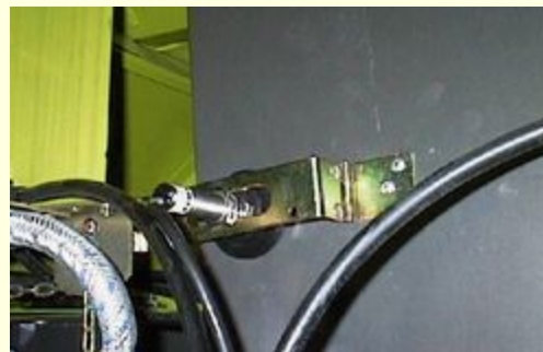
Датчик намолоту - оптична пара "випромінювач - приймач"
