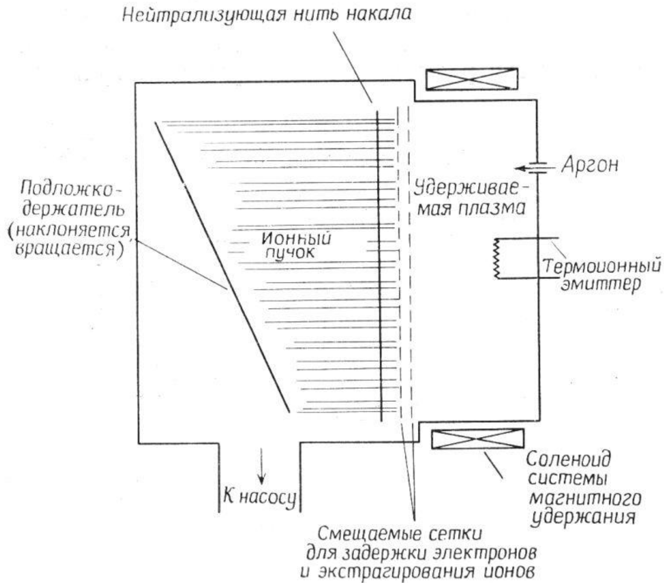
Рис. 8.12. Система для ионно-лучевого травления.
