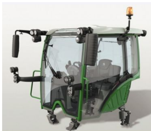
Підвіска кабіни Fendt 500 Vario
