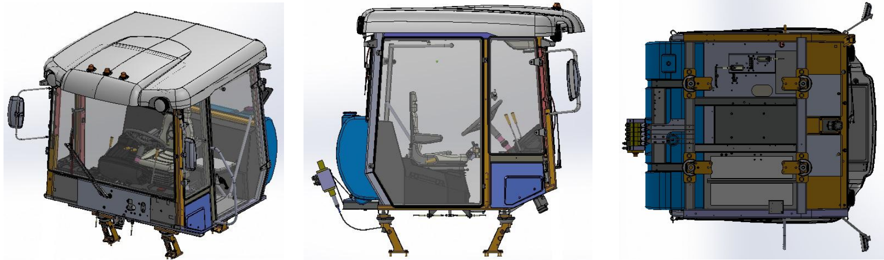
3D зображення класичної будови кабіни колісних тракторів марки ХТЗ
