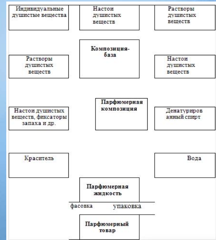
Рис. 1. Общая схема составления рецептуры парфюмерной жидкости.
