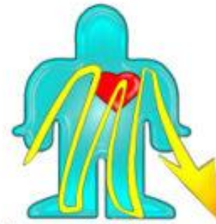
Полная, W-образная петля проходження тока
