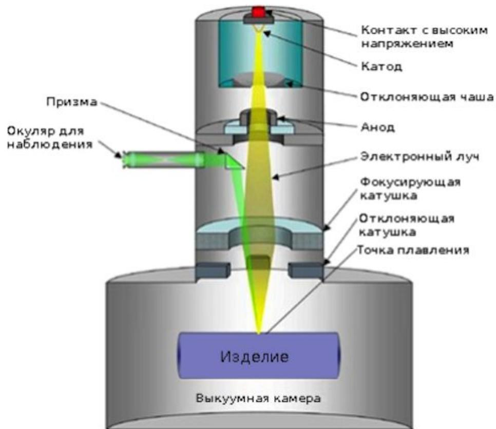
Рис. Принципиальная схема электронно-лучевой плавки (EBM)
