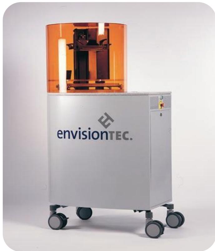
Цифровая светодиодная проекция (DLP)
