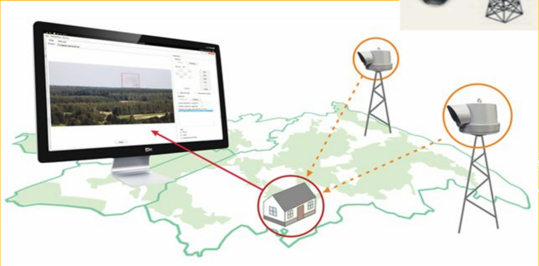
Рис. Типова схема системи раннього виявлення лісових пожеж
