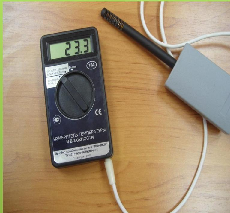
**Прибор для измерения температуры и влажности воздуха**
