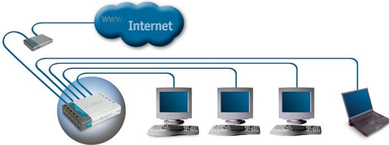
Разработанный специально для использования дома или в малом офисе, DI-604 позволяет быстро и легко подключиться к Интернет посредством DSL или кабельного модема
