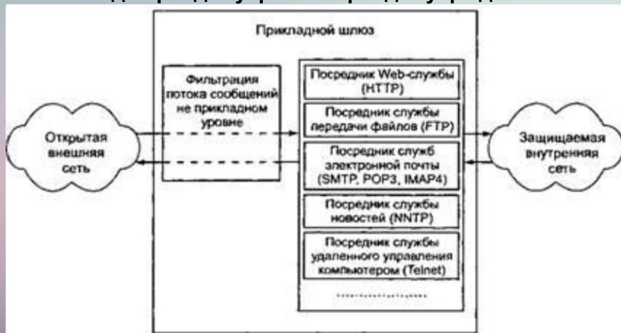
Рис. 9.6. Схема функционирования прикладного шлюза
