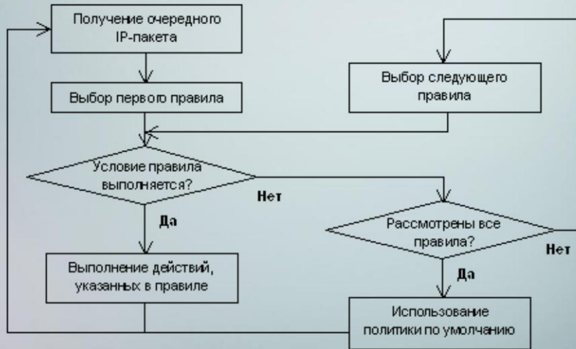
Рис. 3. Модель функционирования простого фильтра пакетов
