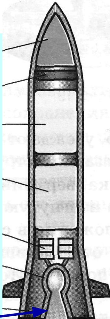
**Сопло** – раструбы специальной формы, через которые газы из камеры сгорания мощной струей устремляются наружу.
