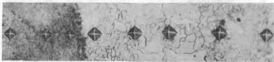
Серия отпечатков индентора микротвердомера в зоне сплавления двух различных металлов.
