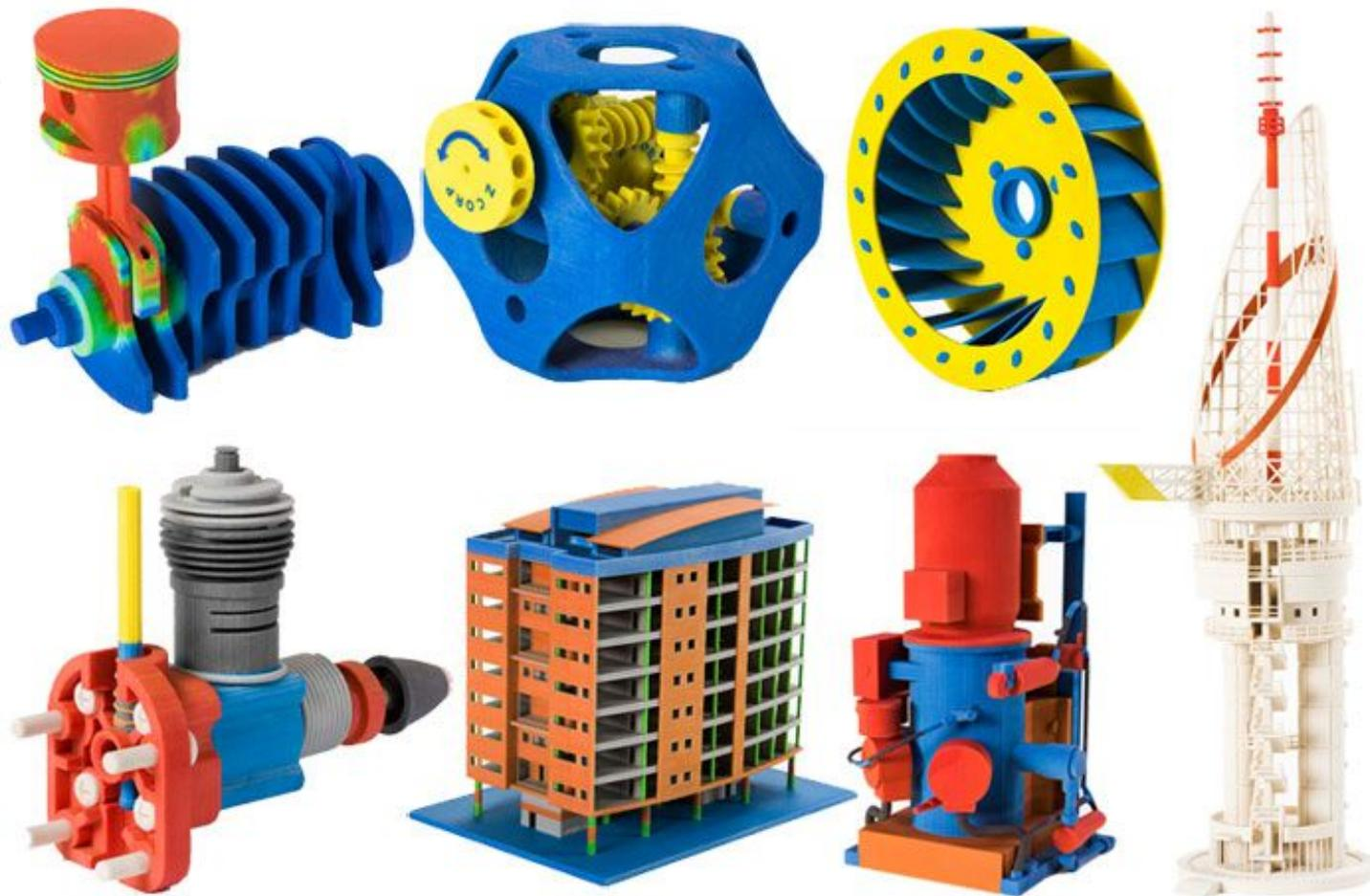
Для получения вещественного макета перед печатью создается его компьютерная CAD-модель в STL-формате. Прототипирование 3D-моделей, чаще всего, происходит при помощи бюджетных моделей принтеров, но с использованием весьма широкого спектра материалов.
