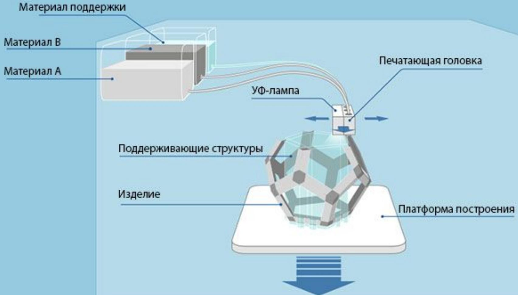
Принцип печати напоминает струйную. В основе технологии — печатающая головка с целой батареей мельчайших сопел, расположенных линейно в несколько рядов. Количество сопел начинается от 96 для младших моделей принтеров и достигает 448 для топовых моделей. Одно сопло — одна мельчайшая капля модельного материала для построения изделия.
