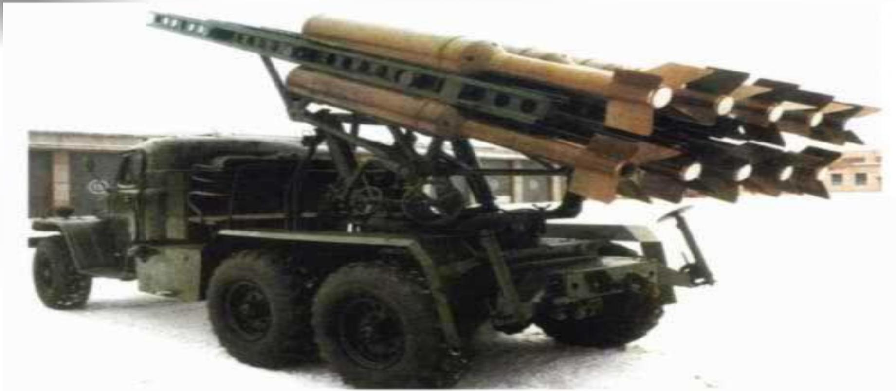
Смонтирована на базе автомобиля высокой проходимости (6 х 6) СА - 30А (аналог советского ЗИЛ-157). Пусковая установка (ПУ) имеет пять парных рельсовых направляющих длиной 4 м. Минирование ведется побатарейно (четыре ПУ). Залп одной ПУ производится за 15с. При стрельбе ракетой типа «74» батарея выставляет заграждение на участке местности площадью 400 х 400 м на максимальную дальность 1 500 м. а при стрельбе НУР типа «85» - 700 х 500 м: и на 3 000 м.
