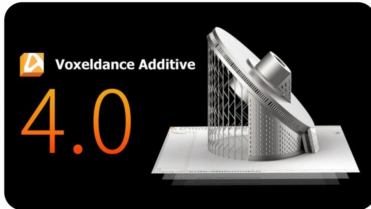
Слайсер – программное обеспечение, преобразующее 3D-модель в набор плоских сечений, согласно которым 3D-принтер перемещает свои узлы и механизмы при 3D-печати. Основной входной формат файла- .stl, выходной формат УП- .gcode
