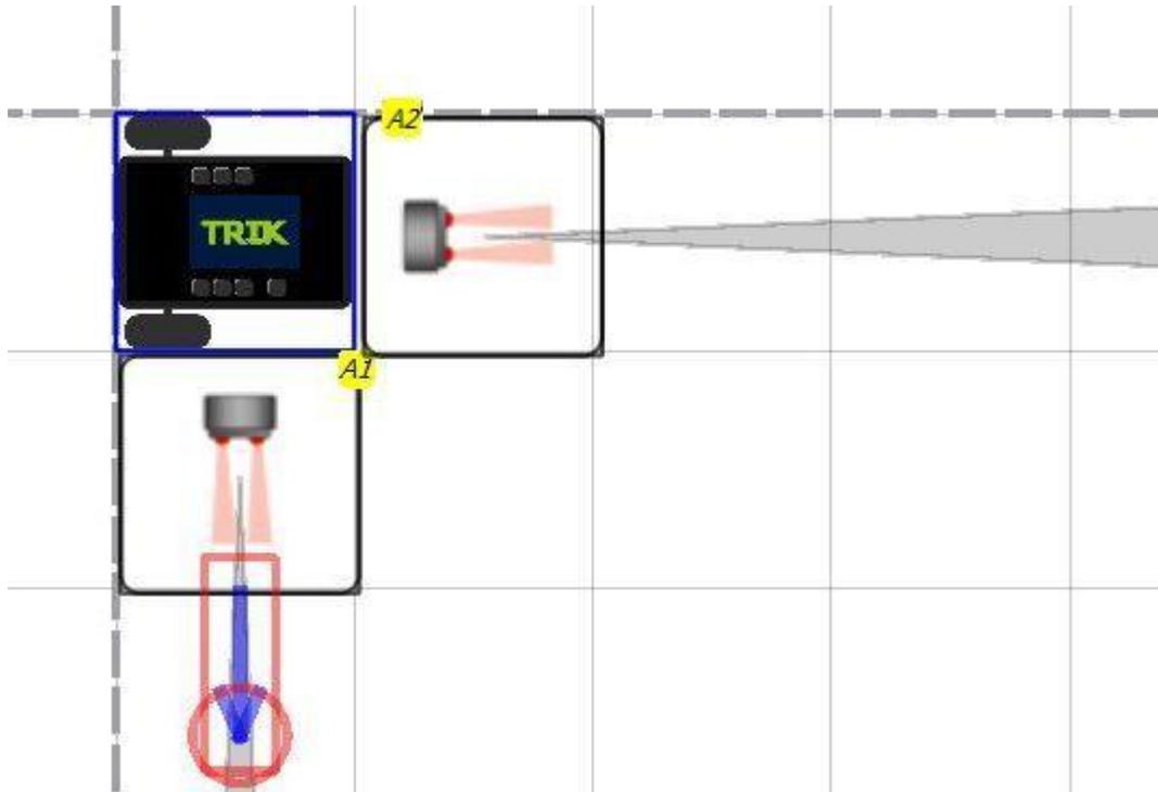
Выступающие за габариты тележки датчики, могут «цепляться» за препятствия.
