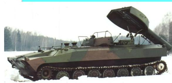
При продельвании прохода в минном поле, установленном в воде у противоположного берега, заряд разминирования подается с исходного берега на противоположный; затем с отходом установки УР-77 назад заряд подтягивается в воду до тех пор, пока головная его часть не окажется у уреза воды, после чего осуществляется взрыв заряда. Подтягивание заряда после его пуска установкой разминирования УР-83П не производится.
