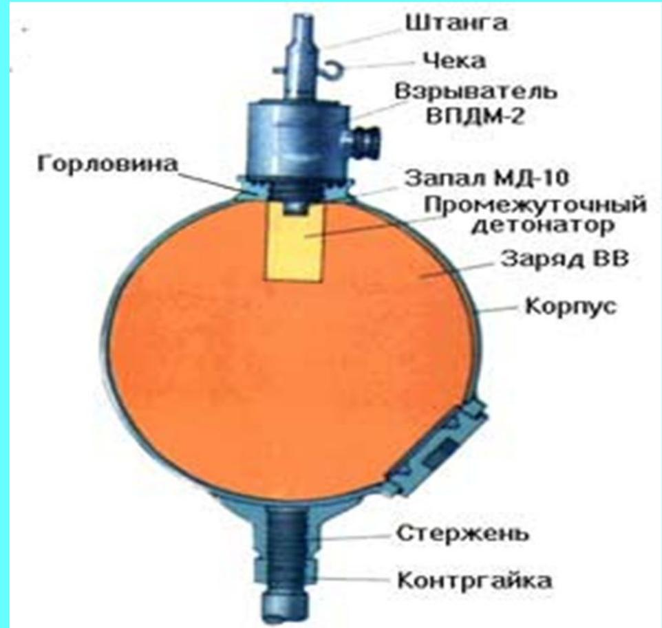
Мина устанавливается на дно водоема на глубине от 1.5м до 3.8 м. вручную с берега или с плав средства. Срабатывает при воздействии на датчик цели с усилием 40-50 кг. (отклонение штанги в любую сторону на 10-15 град.). При взрыве мины в корпусе машины противника образуется пробоина или же при достаточно прочном корпусе гидроудар выводит из строя двигатель и трансмиссию машины (срыв с креплений).
