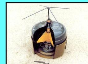
Донные противодесантные мины устанавливаются на глубинах 1...2м в один-два ряда расстояние между рядами 6...10м, расход 170...300 мин на 1км минного поля).
