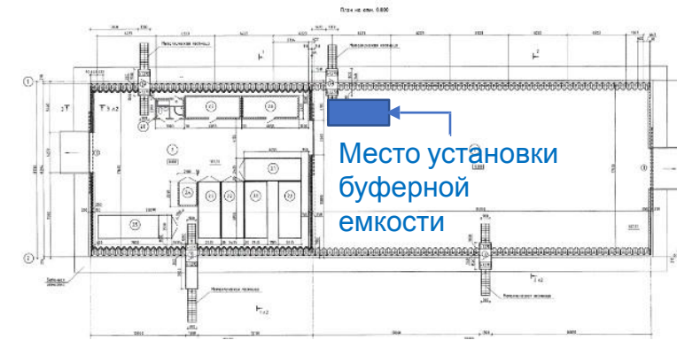
Буферная емкость с терморубашкой для подогрева готовой эмульсии
