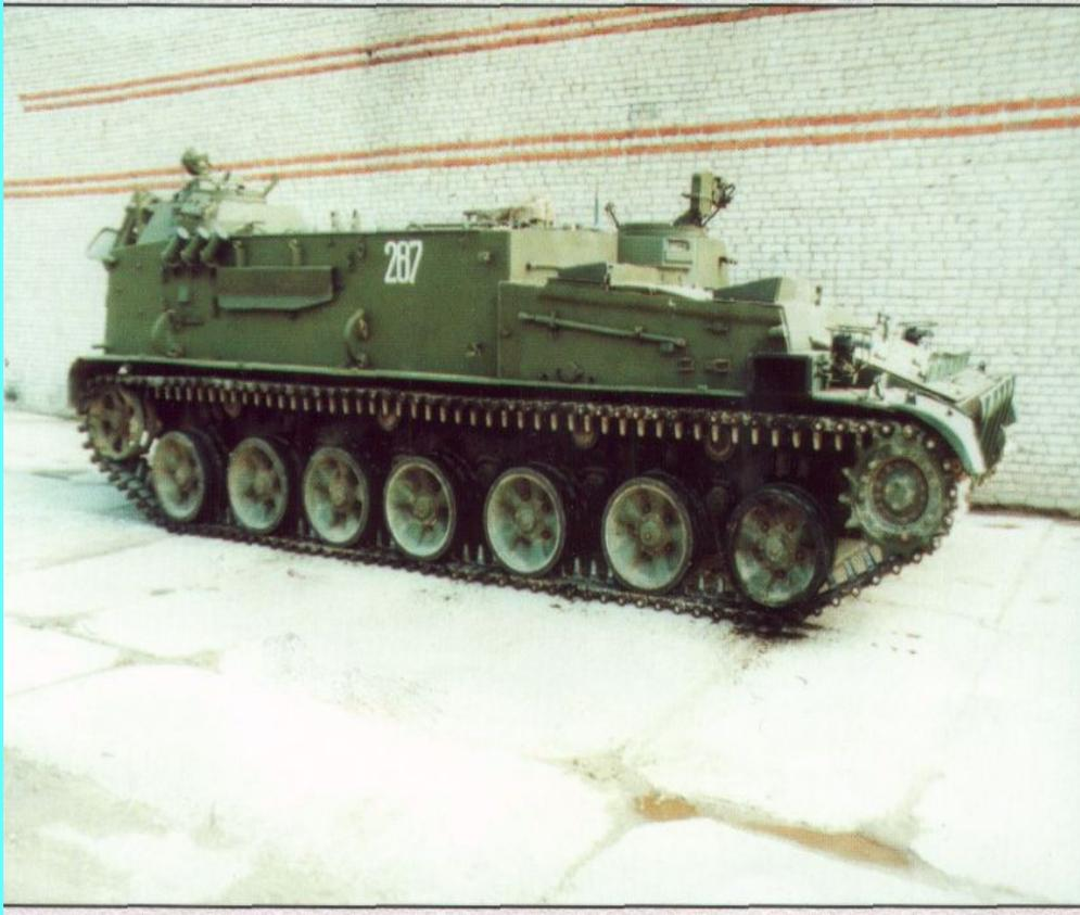
Предназначен для механизированной установки противотанковых мин в ходе боя в грунт (снег) с маскировкой и на поверхность грунта (снега).
