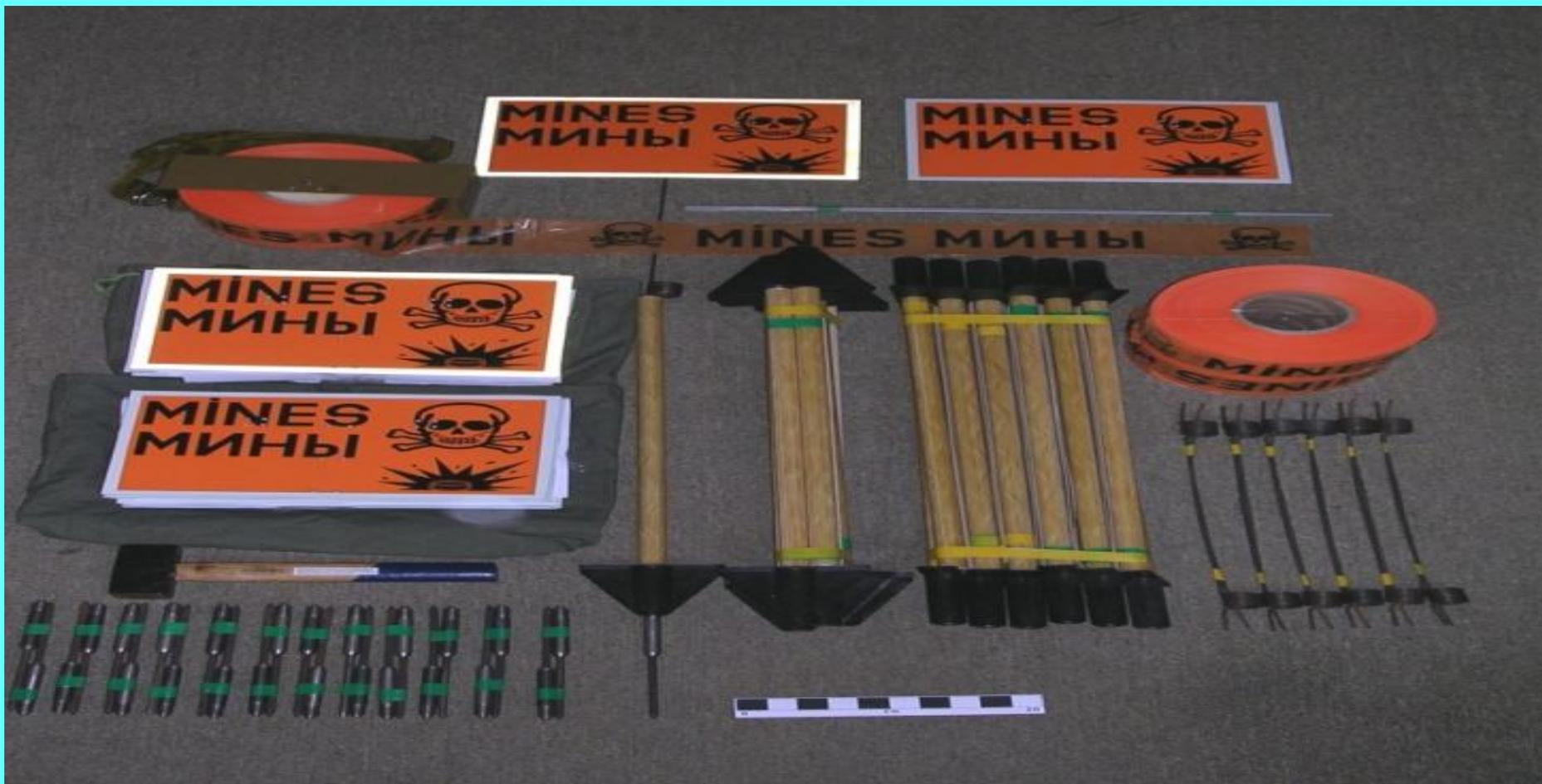
В состав КОМП (рис. 25) входят: ограждающая лента (в катушках), предупредительные знаки, стойки для крепления знаков, отрезки проволоки для крепления знаков на объектах местности, опоры для крепления стоек в грунты, амортизаторы (для крепления знаков к стойкам), устройства для разматывания ленты, сумка для переноски комплекта.
