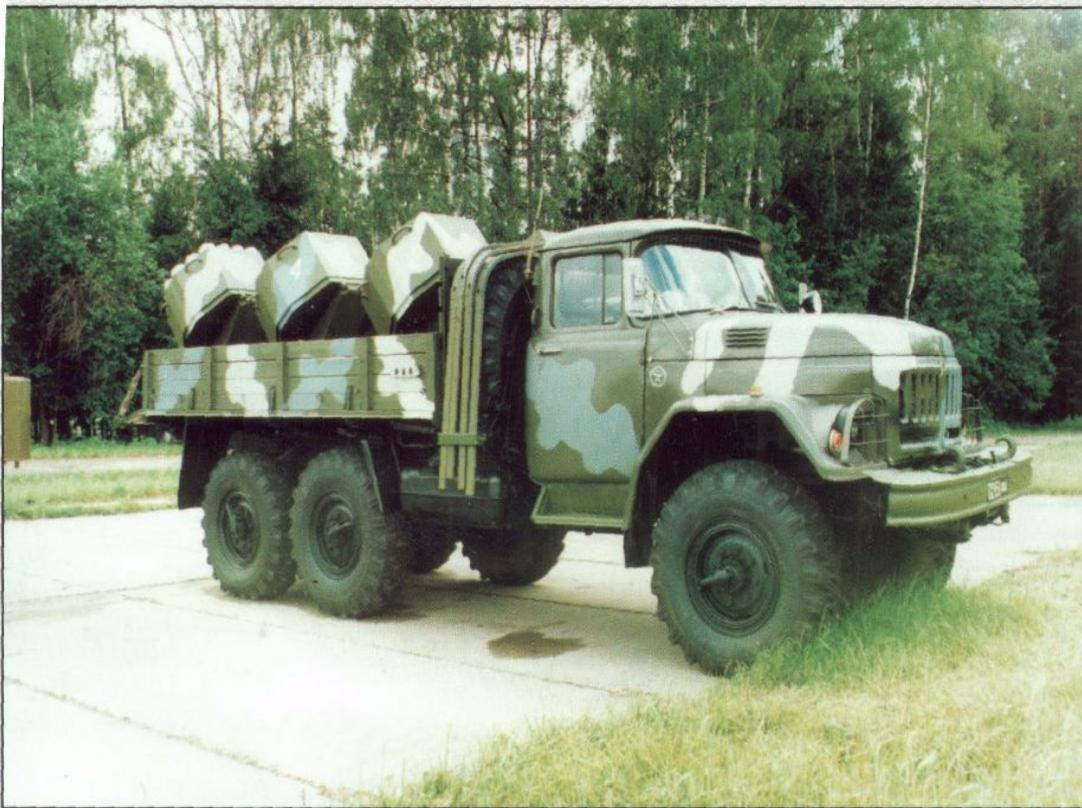
**Предназначен для ускоренного минирования местности противотанковыми, противопехотными и противодесантными минами кассетного снаряжения внаброс.**
