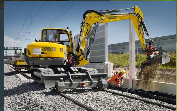
**Ходовое устройство гусеничного типа**, предназначено для передвижения экскаватора в пределах строительной площадки. Оно состоит из рамы и соединенных с ней двух гусеничных тележек. При передислокации с объекта на объект гусеничные экскаваторы перевозят на специальном прицепе при помощи автотягача.
