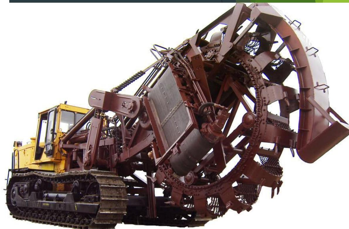
Ширина отрываемых траншей прямоугольного профиля зависит от ширины ковша или скребка и расположения на них режущих элементов.
