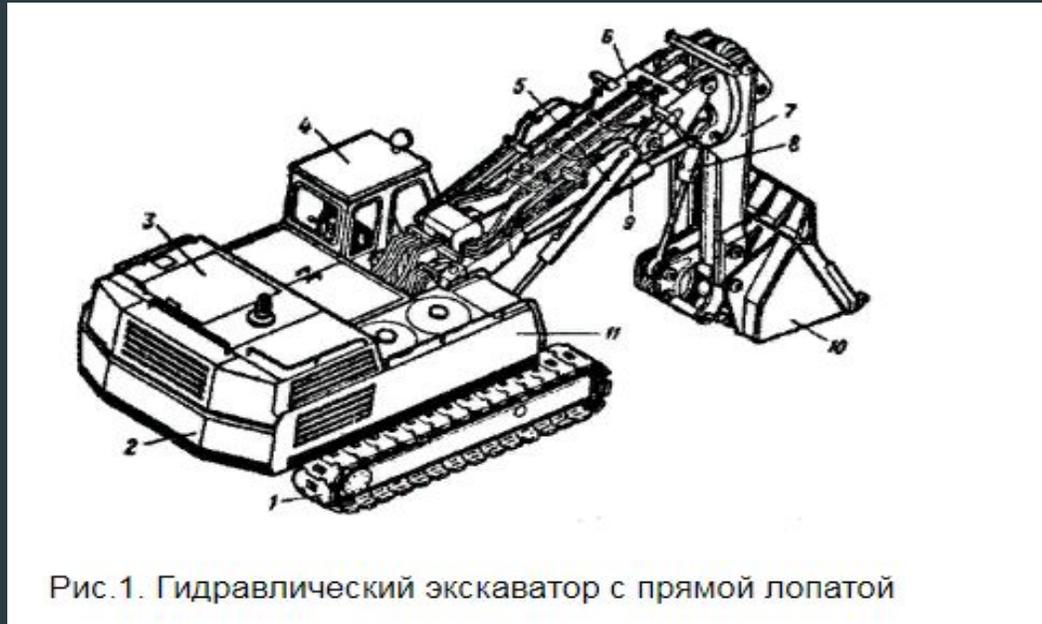
Рис.1. Гидравлический экскаватор с прямой лопатой
