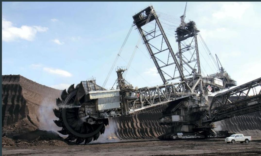
Совместно с другими видами машин и вспомогательного оборудования экскаваторы непрерывного действия образуют технологические комплексы, предназначенные для выполнения различных видов работ при строительстве нефте- и газопроводов, оросительных и осушительных каналов, устройстве дренажных систем, закрытых напорных водоводов, добыче и переработке нерудных строительных материалов, строительстве подземных кабельных линий связи и электропередач, других коммуникаций.
