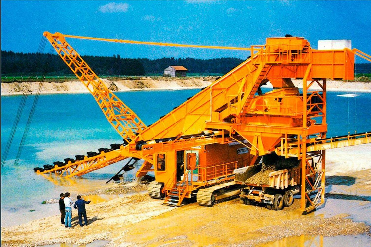
Многоковшовые экскаваторы являются самоходными землеройными машинами непрерывного действия, которые при своем поступательном движении отрывают позади себя продольную выемку - траншею определенной глубины и ширины.
