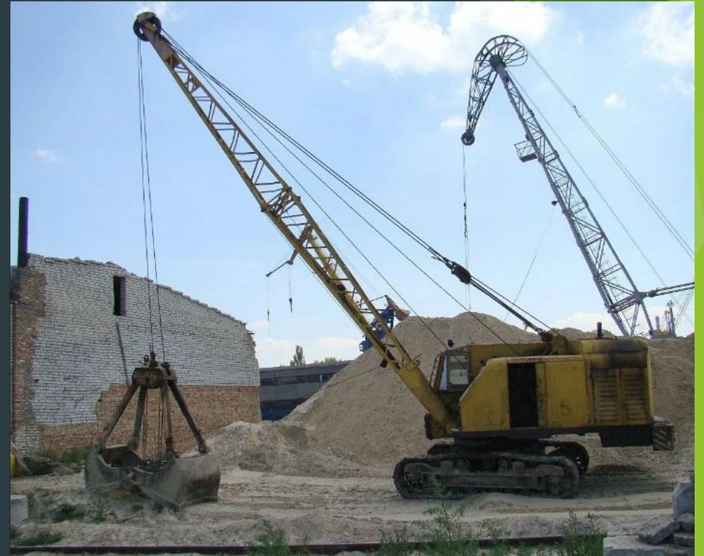
**По типу подвески** рабочего оборудования различают экскаваторы с гибкими элементами (преимущественно канатами) для удержания и приведения в действие рабочего оборудования (**гибкая подвеска**) и с жесткими элементами - преимущественно гидравлическими цилиндрами (**жесткая подвеска**).
