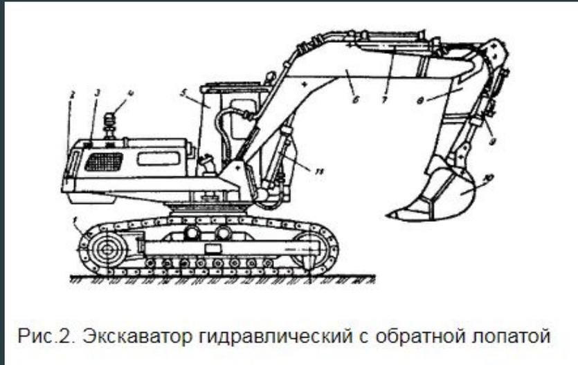
Рис.2. Экскаватор гидравлический с обратной лопатой
