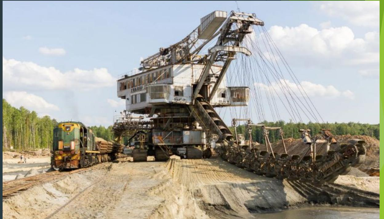
Рабочим органом роторных экскаваторов является жесткий ротор (колесо) 12 с ковшами или скребками 11, вращающийся на роликах 8 рамы 9.
