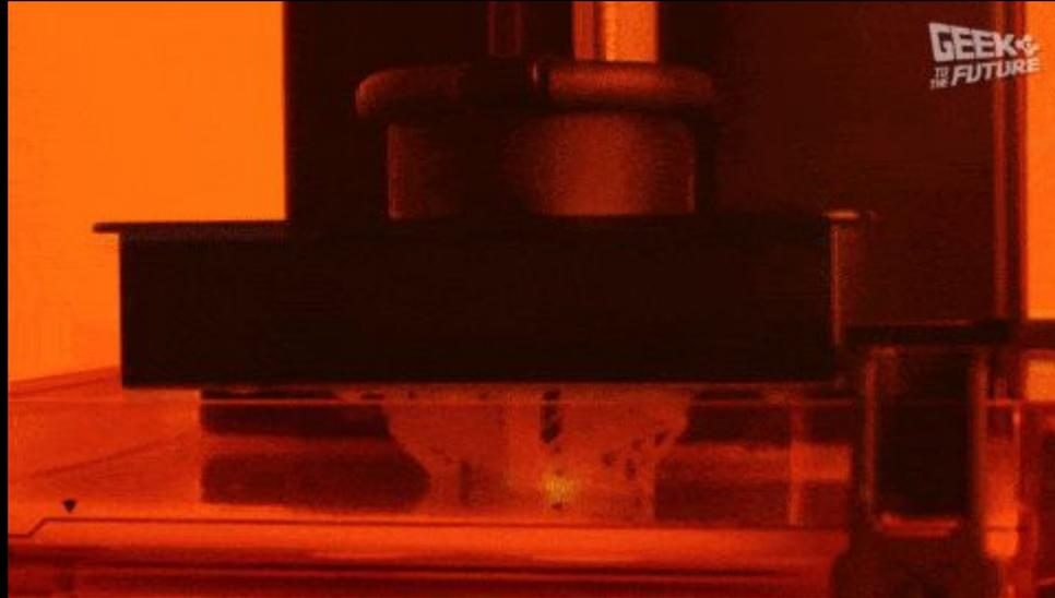
Суть SLA-технологии заключается в использовании жидкого фотополимера и специального реагента, который позволяет исходному материалу застывать под воздействием ультрафиолетового лазера.
