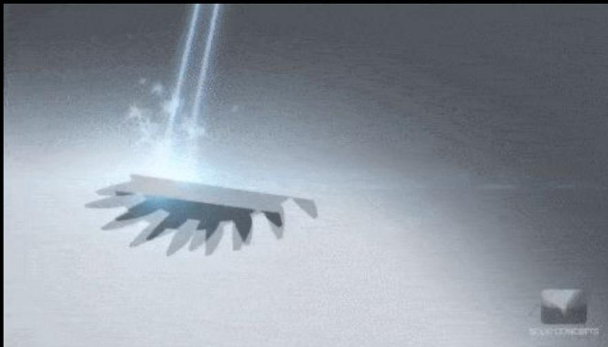
Метод SLS основан на равномерном распределении специального порошка с последующим его плавлением под воздействием лазера, в соответствии с геометрией сечения каждого слоя изделия. По завершении печати, необходимо удалить порошок, снять изделие со вспомогательных подпорок и выполнить минимальные доработки по доведению детали до кондиции.
