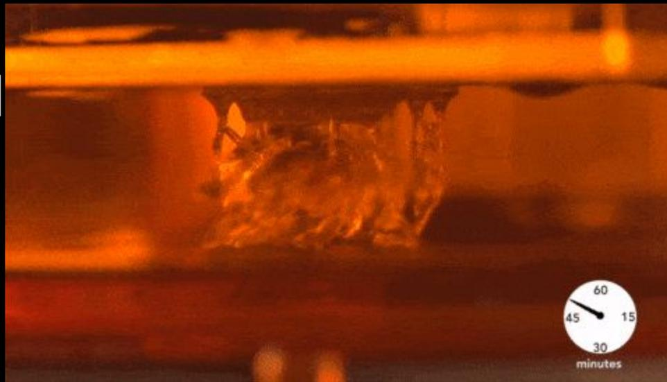
DLP метод аналогичен лазерной стереолитографии. Отличие заключается в том, что засветка платформы осуществляется проекциями слоев 3D-модели, в следствие чего смола застывает в нужных областях.
