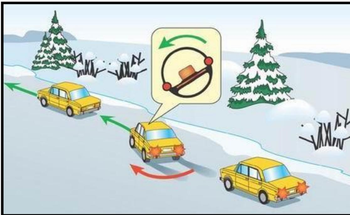
Если **ПЕРЕДЕРЖАТЬ РУЛЕВОЕ КОЛЕСО** повернутым налево, то, возвращаясь на место, задняя часть машины может по инерции «перелететь» через продольную ось направления движения, и тогда опять начинается занос, но теперь уже в другую сторону. Избежать повторного заноса можно, если воспользоваться «опережающим воздействием на рулевое колесо».
