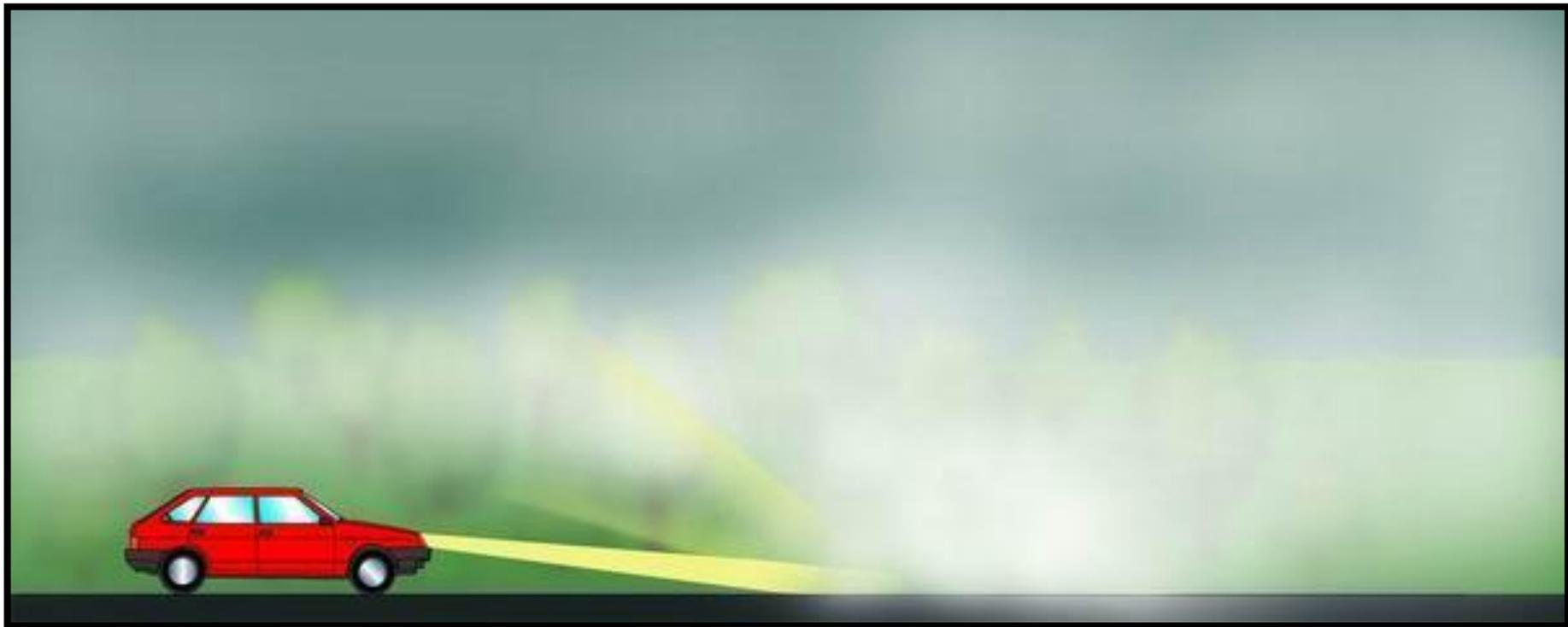
**Если переключить** свет фар на **БЛИЖНИЙ** эта стена становится чуть более рыхлой и отодвигается немного дальше от машины.
