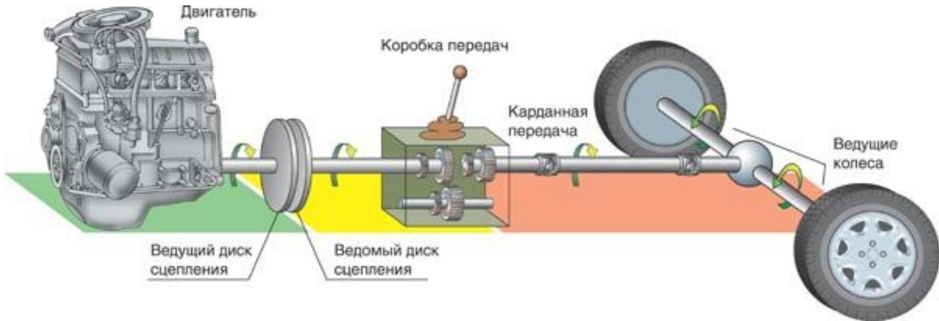
Если педаль «газа» отпустить, двигатель прекращает отдачу крутящего момента и **силы инерции движения**, которые запас автомобиль, **пытаются прокручивать коленчатый вал двигателя через ведущие колеса в обратном по схеме порядке**. И это им удастся, но с трудом. Вот это и есть торможение двигателем.
