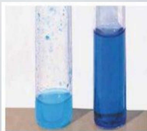
Мал. 32.1. Свіжоосаджений купрум(II) гідроксид (ліворуч) та після додавання гліцеролу (праворуч)
