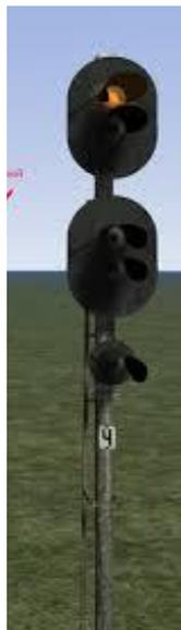
2) **выходные** – разрешающие или запрещающие поезду отправиться с железнодорожной станции на перегон;
