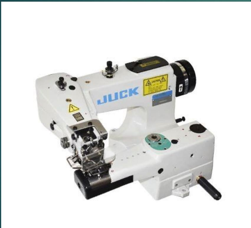
Подходит для обработки потайным стежком внутренней стороны поясной части брюк, закрепления подогнутых краев тонких материалов и тканей
