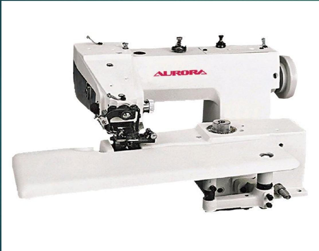
Машина предназначена для выполнения потайного стежка (подшивание низа платья и брюк, края подкладки, нижнего подворотника, кромки и т.д.) и позволяет обрабатывать изделия из широкого спектра материалов по толщине. Машина имеет рукавную платформу и откидной столик.
