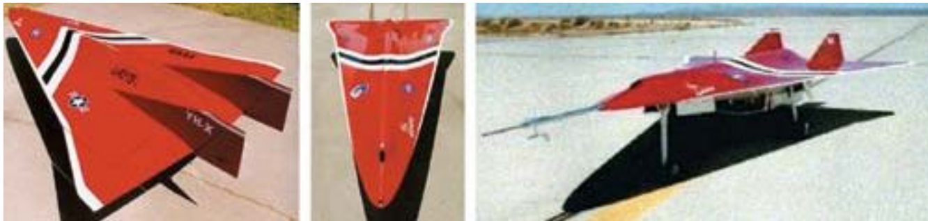
Гиперзвуковой самолет-разведчик LoFLYTE (фотографии Accurate Automation Corp и NASA)
