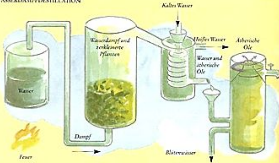
Wasserdampfdestillation, wie sie heute praktiziert wird
