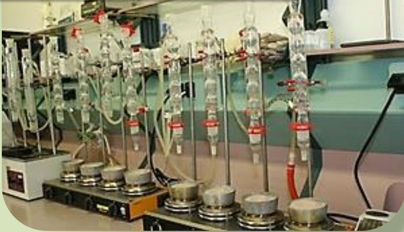
Wasserdampfdestillation, wie sie heute praktiziert wird
