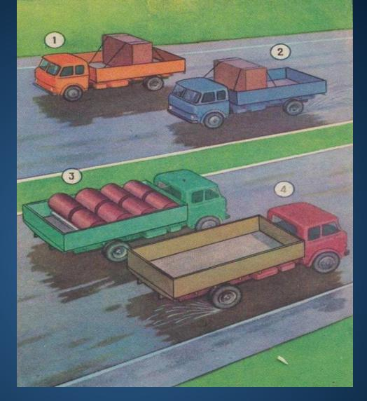
Почему на одной и той же дороге автомашины 1 и 3 не буксуют, а автомашины 2 и 4 могут буксовать?
