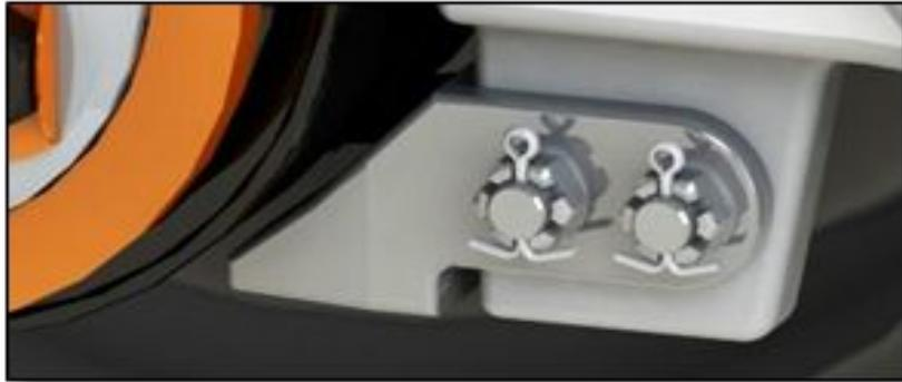
Устройства, предотвращающие выход колесных пар из буксовых проемов боковых рам
