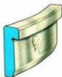
Коррозионные и усталостные раковины на дорожке качения внутреннего кольца
