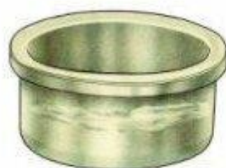
Шелушение и задиры на дорожке качения внутреннего кольца
