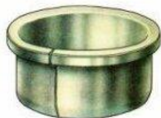
Трещины и разрывы внутреннего кольца
