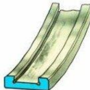
Рифление и шелушение дорожки качения наружного кольца
