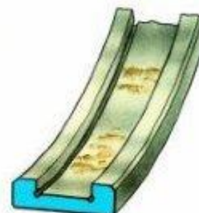
Поверхностная коррозия на дорожке качения наружного кольца
