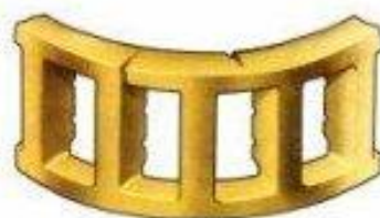
Трещины и излом сепаратора
