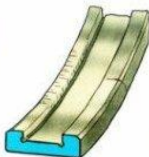
Задиры и трещины на бортах наружного кольца
