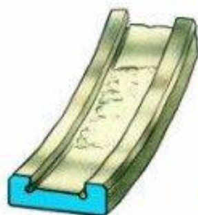
Усталостные раковины на дорожке качения наружного кольца
