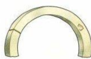
Трещины и изломы алюминиевого упорного кольца (приставной шайбы)
