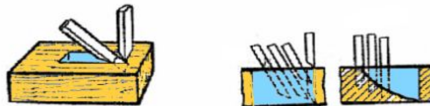
Последовательность долбления гнезда
